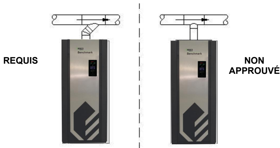
Figure 11a : raccords requis au collecteur d'évacuation commun
