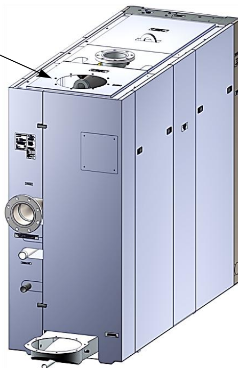
Figure 8d : raccordement à conduit d'air de combustion pour les chaudières BMK5000 et 6000
