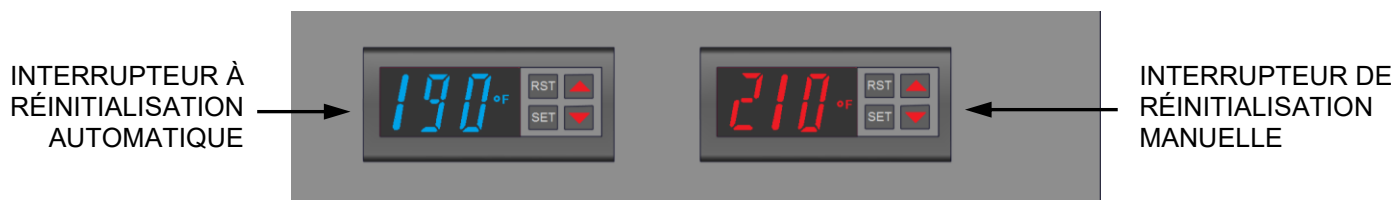
Figure 4-11: Interrupteurs de fin de course de surchauffe
