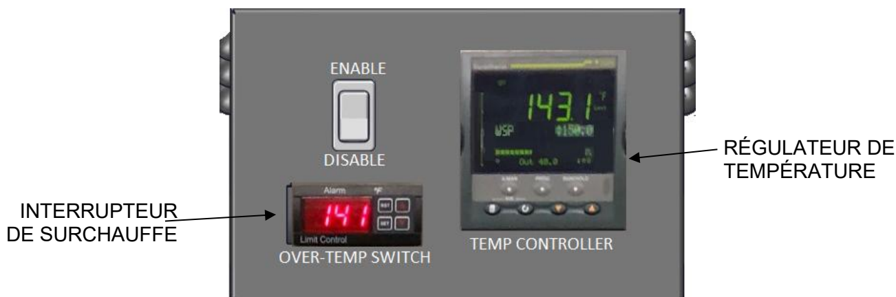
Figure 8-6 : Interrupteur de surchauffe et régulateur de température
