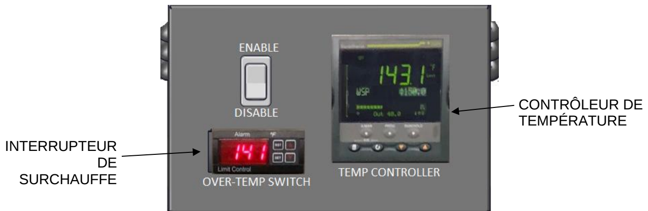
Figure 8-6: Interrupteur de surchauffe et contrôleur de température
