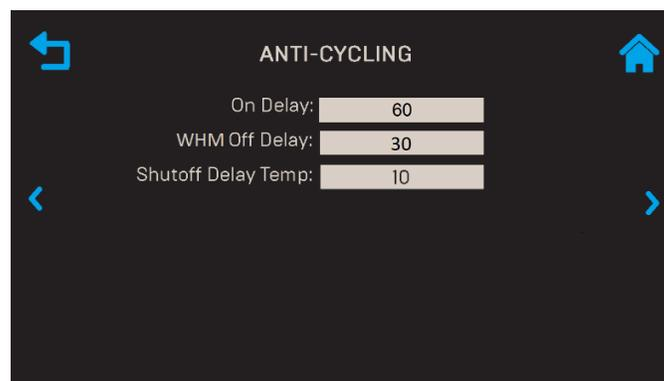
**Figure 8.6-5 : Contrôles de fonctionnement : Écran Contrôle anti-cycle**
