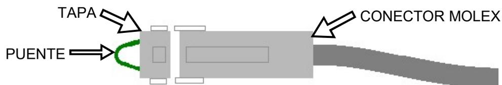
**Figura 2-17: Conector Molex de válvula de aislamiento secuencial y cable de puenteo**
