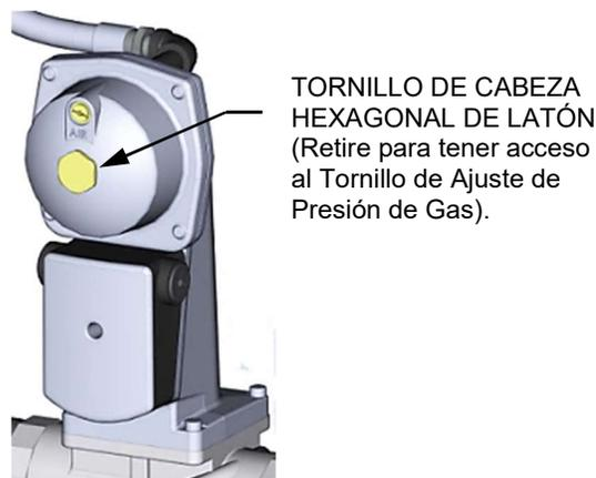
**Figura 4-3: Ubicación de Tornillo de Ajuste de Presión de Gas**
