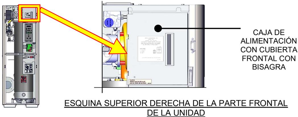
**Figura 2-9a: Caja de alimentación con cubierta cerrada de BMK 750/1000**
