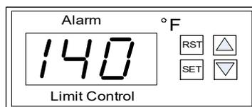
**Figura 4-7: Panel frontal del interruptor digital de alarma por sobretemperatura**
