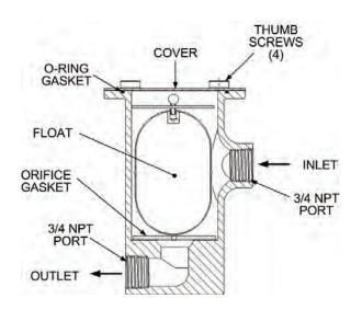
Figure 6-9. External Condensate Trap
