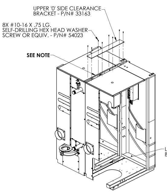
NOTE: BEFORE PLACING THE 2 UNITS SIDE-BY-SIDE TOGETHER, REMOVE THE SIDE PANELS IN BETWEEN FIRST.
